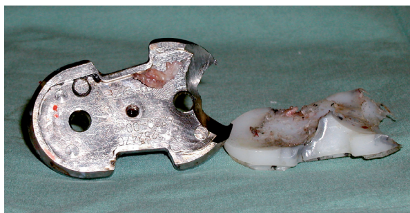
Obr. 1.6 Těžká usurace polyethylenové vložky včetně pod ní ležící kovové tibiální komponenty v důsledku dlouhotrvajícího asymetrického zatížení u pacienta, který nedocházel řadu let na kontroly
