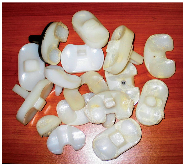
Obr. 1.5 Polyethylenové komponenty zůstávají bez ohledu na svoji konstrukci a použitý materiál nejslabším článkem kloubní náhrady a jejich poškození nebo opotřebení je nejčastějším důvodem revizní operace
